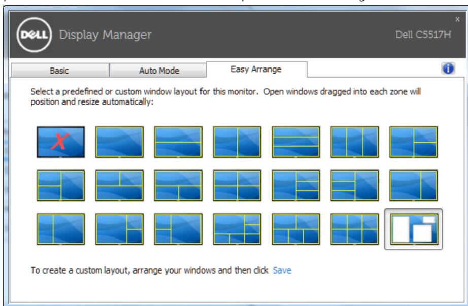
Para crear un diseño de ventanas personalizado, en primer lugar ajuste el tamaño y la posición de hasta 10 ventanas en el escritorio y, a continuación, haga clic en el vínculo Guardar en Easy Arrange. El tamaño y la posición de las ventanas se guardan como un diseño personalizado y se crea un icono para dicho diseño.
